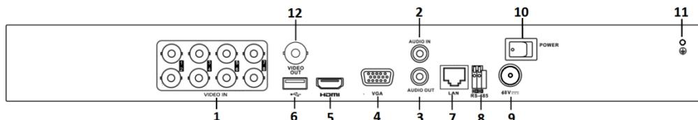
\*Задняя панель DS-7204HQHI-K1/P и DS-7216HQHI-K2/P имеет 4/16 видеовходов
